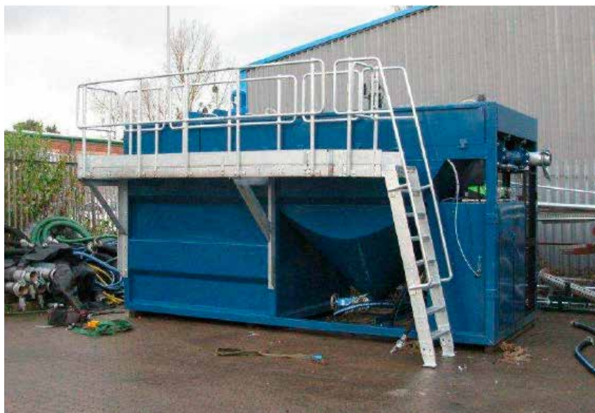
Mobil anläggning för fällning/flockning och sedimentering.
