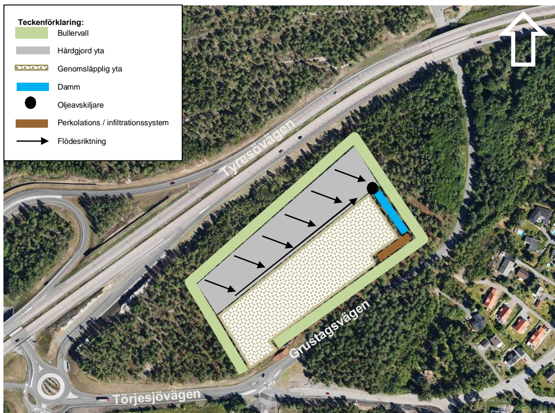
Figur 3. Föreslaget system för dagvattenhantering. Figuren är ej skalenlig och är endast en schematisk bild av området.
