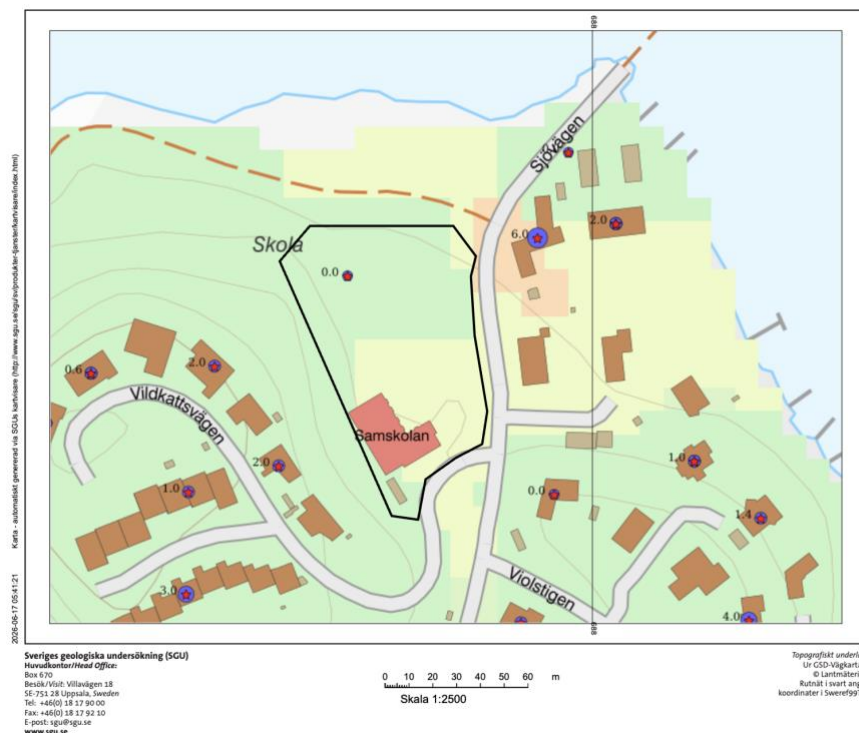
Figur 2. Utdrag från SGU:s Jorddjupskarta. Fastighetens ungefärliga placering är markerad med svart. Grön färg indikerar skattat jorddjup om 0 meter, gul färg jorddjup om 0-3 meter och röd stjärna observerade jorddjup (SGU:s kartvisare, 2026).
