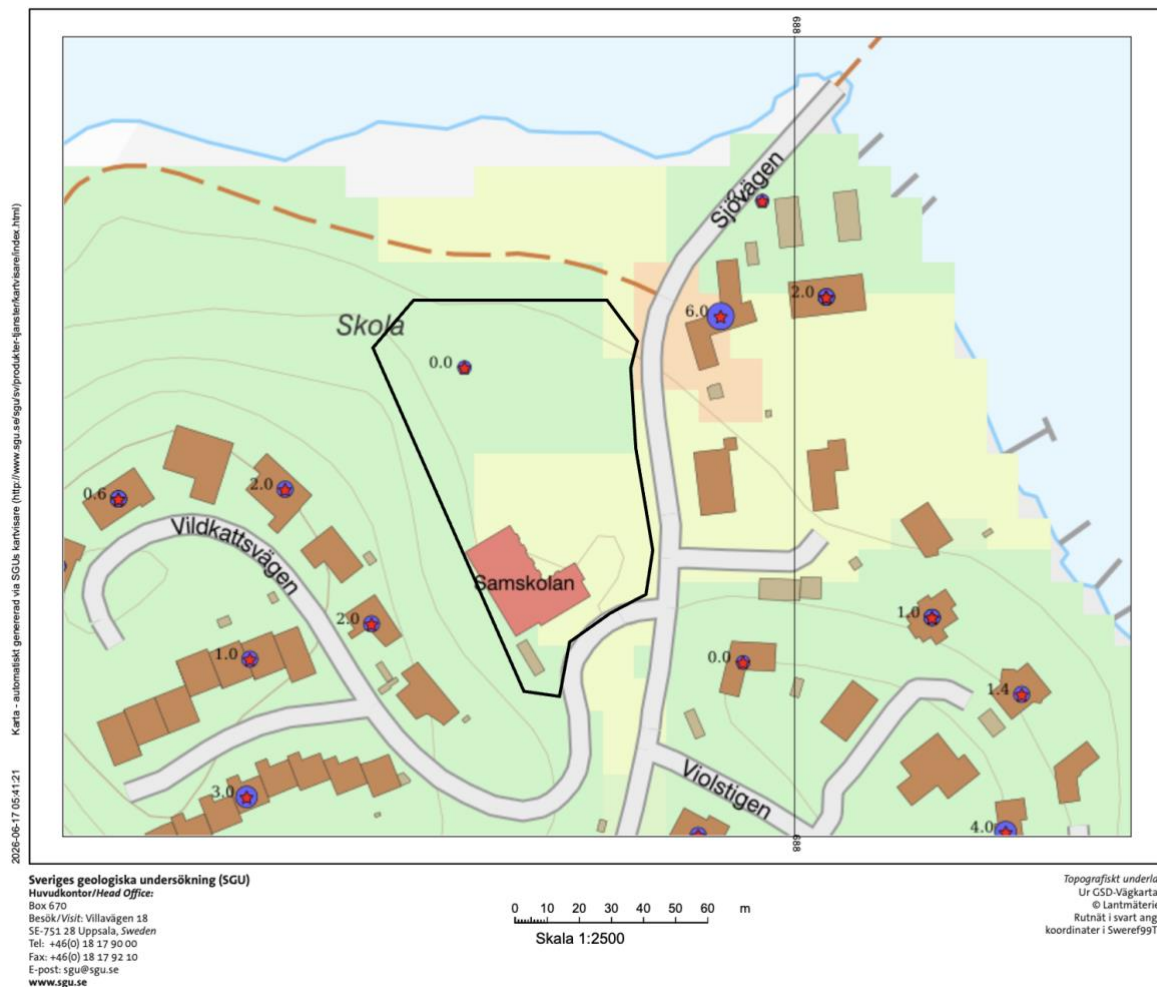
Figur 3. Utdrag från SGU:s Jorddjupskarta. Fastighetens ungefärliga placering är markerad med svart. Grön färg indikerar skattat jorddjup om 0 meter, gul färg jorddjup om 0-3 meter och röd stjärna observerade jorddjup (SGU:s kartvisare, 2026).
