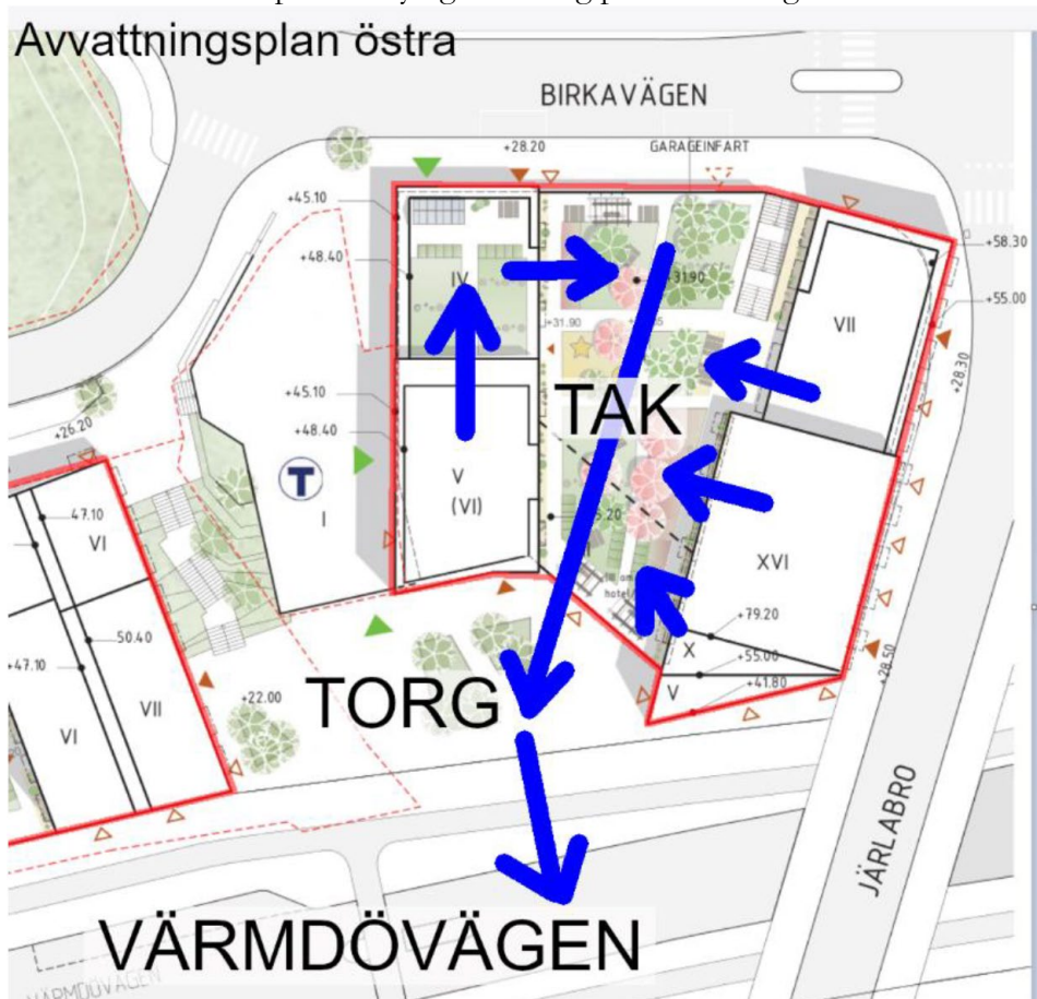
Figur 47. Avvattningsplan för östra kvarteret vid extrema skyfall. Blå pilar indikerar flödesriktning för bräddande dagvatten.
