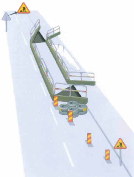
Figur 87. Exempel på omledning av gående vid arbete på gångbana.
