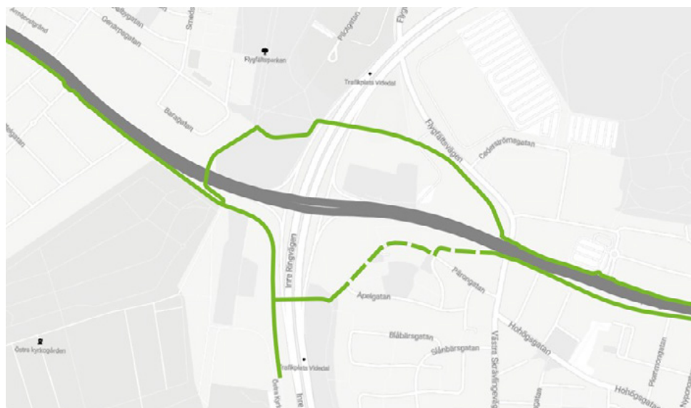
Figur 20. Sammanhängande och gent cykelstråk är viktigt såväl i som mellan tätorter. "Vid trafikplatser är det inte ovanligt att cykelvägen går i långa omvägar medan bilvägen fortsätter rakt fram" skriver Cykelfrämjandet. 37
