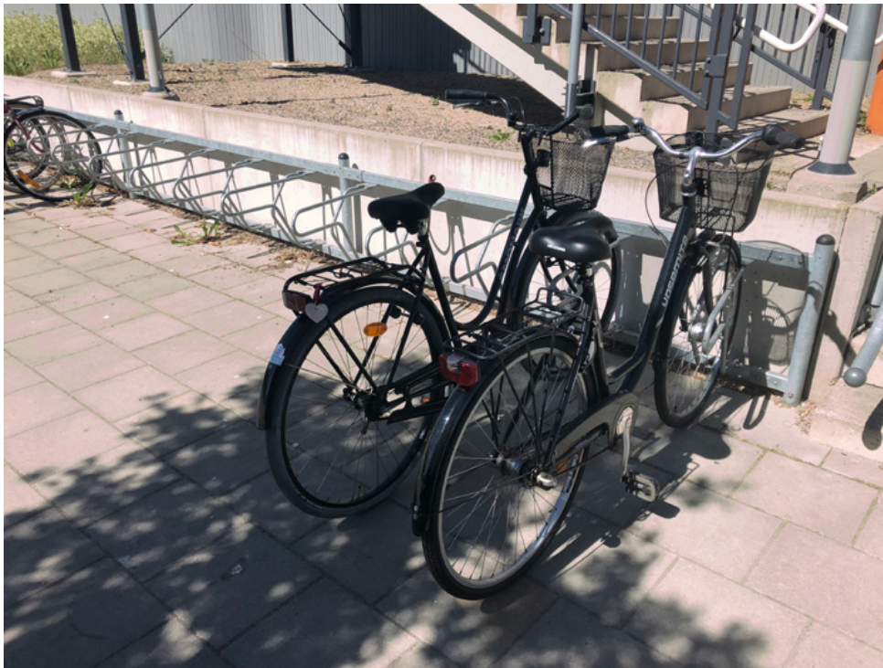
Figur 76. Hjulhållande cykelställ med möjlighet till ramlåsning vid stationen i Önnestad.
